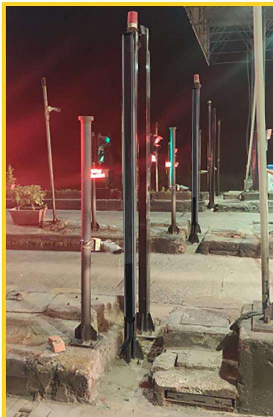
Le barriere Micron, poste all'uscita di ogni corsia per il pagamento pedaggio, tramite l'interfaccia seriale RS 485 possono essere collegate ad un controller e trasmettere lo stato dei raggi:
