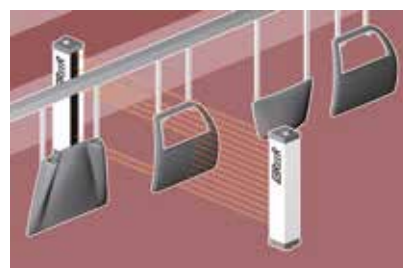
Detecção de posição e perfil de peças em sistemas automáticos de pintura
