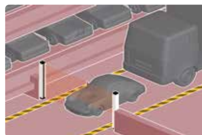
Detecção do limite dimensional total de veículos para estacionamentos automáticos
