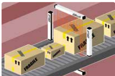
Medição da altura de objetos em trânsito em sistemas de transporte. Detecção bidimensional de objetos em trânsito com o uso de 2 cortinas de luz
