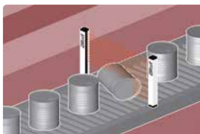
Controle de qualidade: verificação do correto posicionamento dos objetos
